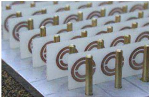
**Figure 1.7** Structure proposée par D. Smith et al [6] qui combine les fils minces et les SRR pour avoir un milieu doublement négatif (métamatériau)
