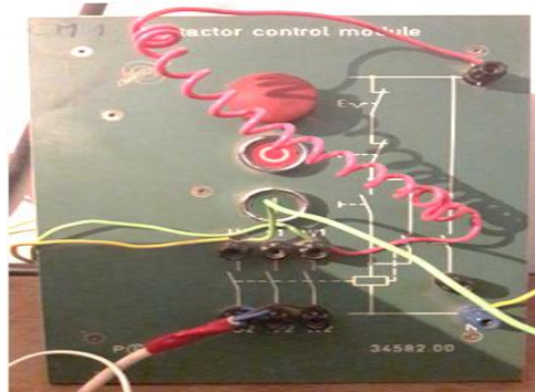
Fig (II.8) : Image du module de contrôle des contacteurs et boutons de marche
