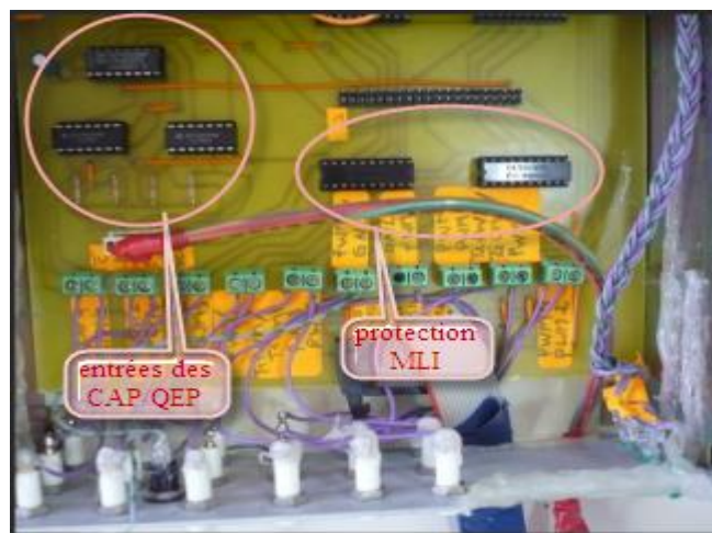
Figure III.13 : Circuit de protection des entrées / sorties logiques
