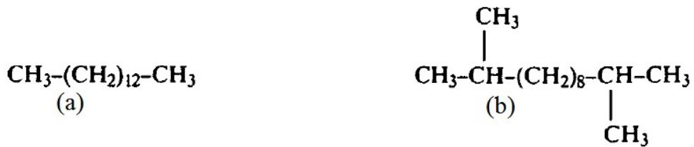
Figure 1.1 : Structures moléculaires d'hydrocarbures paraffiniques (a) : chaîne simple (b) : chaîne ramifiée [17].
