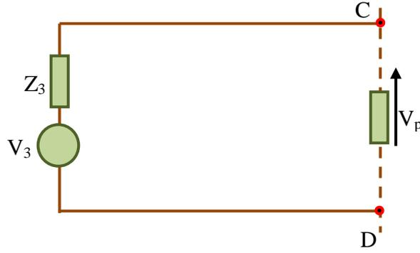
**Fig. III.14.** Circuit électrique final simplifié équivalent à une enceinte munie d'ouverture
