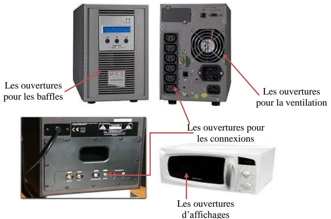
**Fig. III.5.** Enceintes métalliques munies de différents types d'ouvertures.
