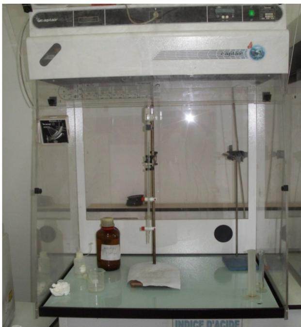
Figure (II.7) : dispositif de mesure de l'acidité
