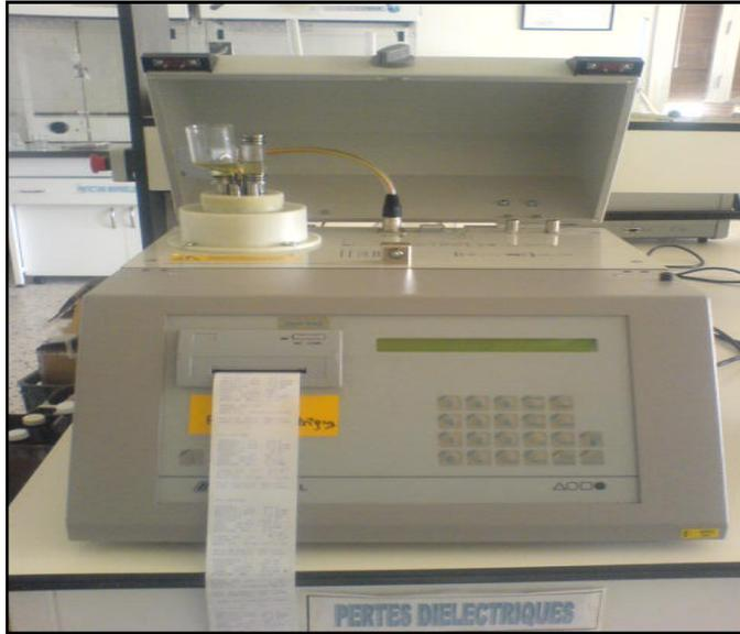
*Figure (II.5) : Appareil de mesure des pertes diélectrique*
