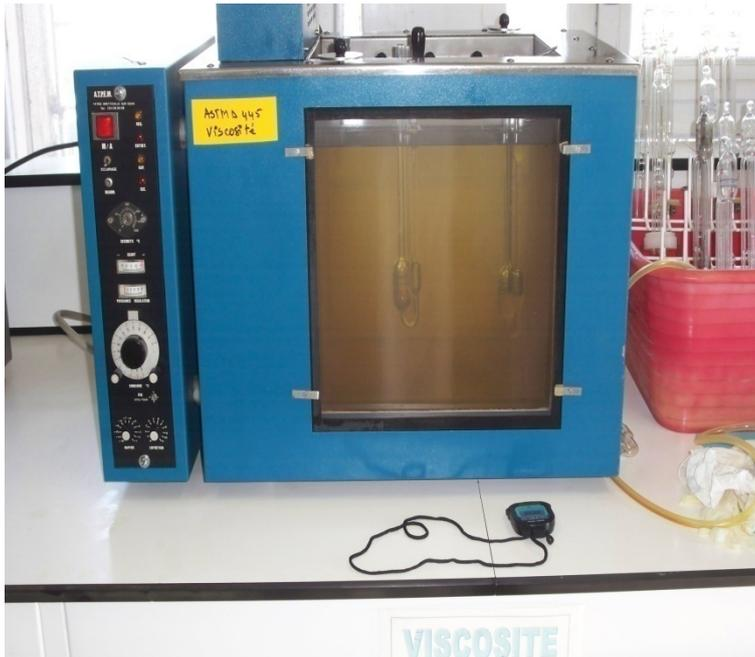
Figure (II.8) : Appareil de mesure de la viscosité
