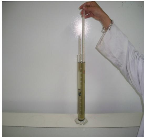
Figure (II.6) : Appareillage de mesure de la densité (éprouvette, densimètre et thermomètre)
