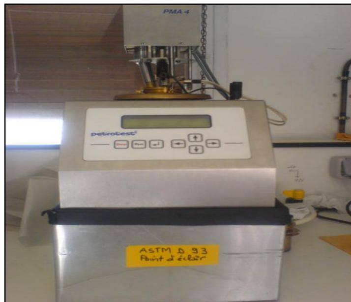
Figure (II.10) : Appareil de mesure du point d'éclair
