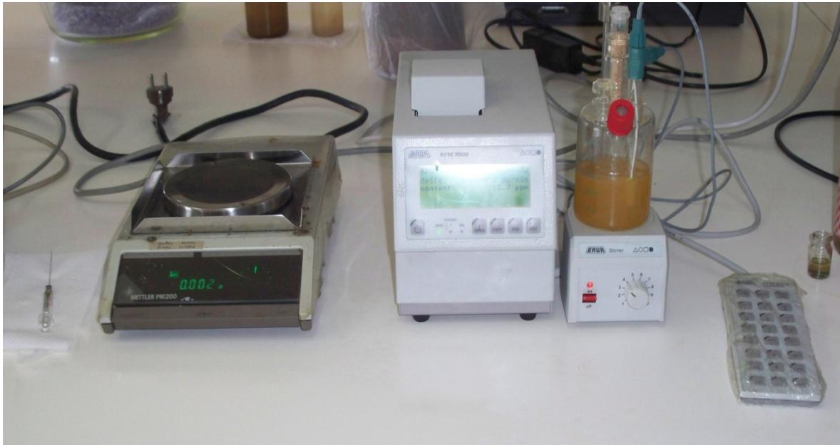
Figure (II.2) : Appareil de mesure de la teneur en eau
