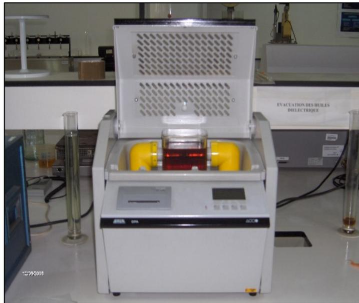
Figure II.5. Appareil de mesure de la tension de claquage.
