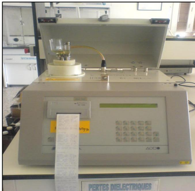
**Figure II.8.** Appareil de mesure de  $\tan \delta$ ,  $\epsilon_r$  et  $\rho$ .
