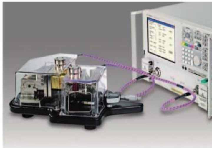
Figure I.5. Cavité résonnante 85072A opérant 10 GHz [72]
