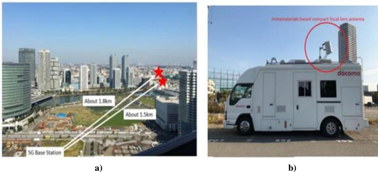
Figure II.12. a) scénario de l'expérience effectuée par Huawei et NTT DOCOMO. b) Antenne-lentille à base de métamatériau embarquée dans un véhicule. [39].
