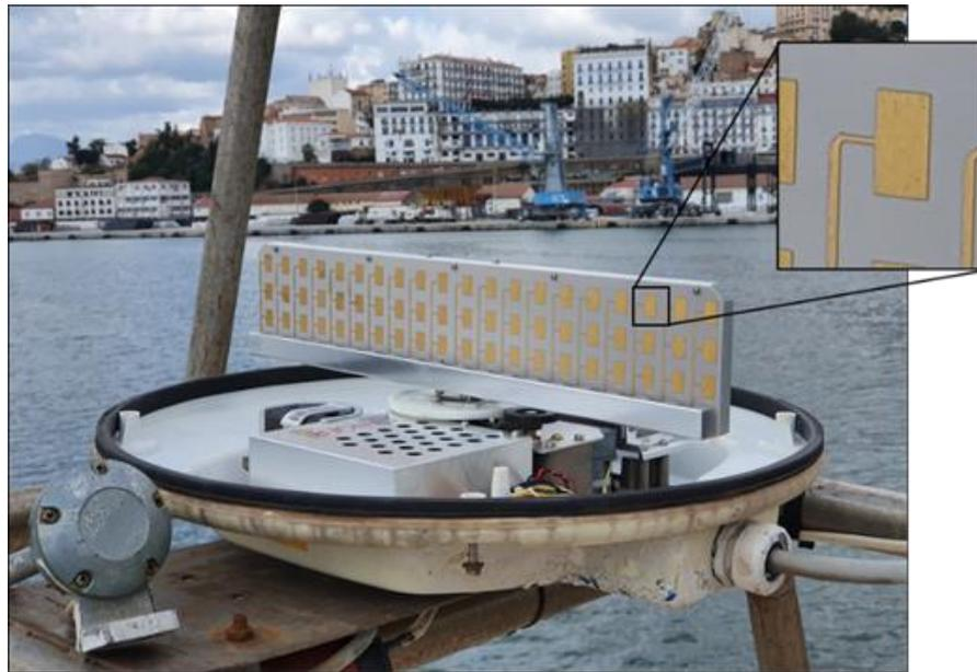
*Figure II.3. Réseau d'antennes patches, Radar KODEN MDC-921, Port Bejaia.*
